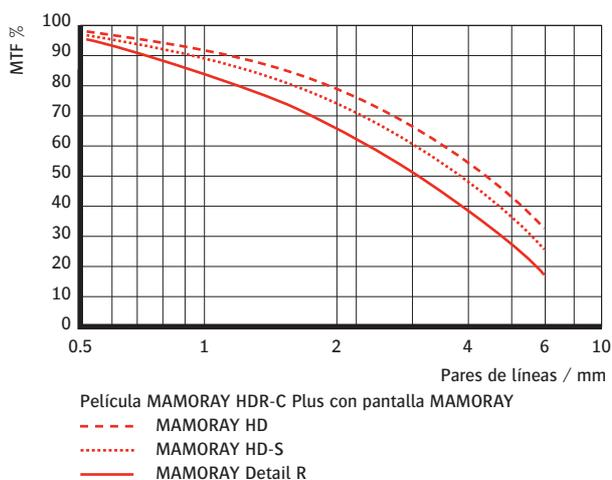
Esta curva es el resultado de las mediciones que proporcionan un nivel de "nitidez intrínseca" del sistema de película / pantalla. Es una medición parcial de la calidad de imagen total del sistema de película / pantalla según se percibe en el negatoscopio. La calidad de imagen total depende de otros factores, además de la "nitidez intrínseca". Los principales factores son: granulación, ruido, contraste de la película y factores estéticos, como la densidad de la película, tono de imagen, etc.
